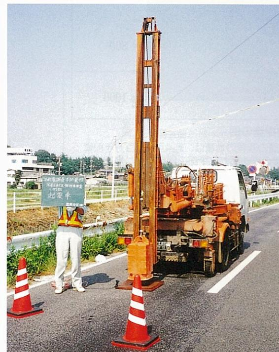
写真 3-5 反射法弾性波探査の実施状況
